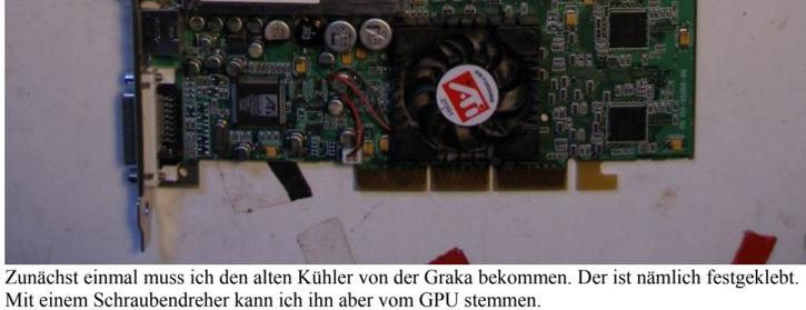
Kein Wunder, dass der kleine Lüfter versucht, die Festplatte bei den Umdrehungen pro Minute einzuholen. Dieser Kühlkörper ist kaum mehr als eine dünne Aluplatte. Mit Alkohol entferne ich die Reste vom Wärmeleitkleber.
