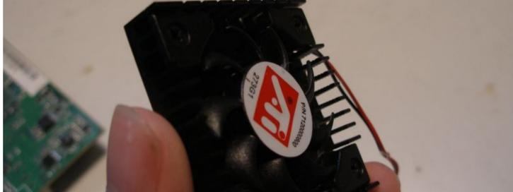
Die Radeon hat praktischer Weise schon Löcher zum Befestigen eines Ersatzkühlers (ja, notfalls hätte ich mir welche gemacht). Lochabstand messen, Kühler markieren, könen und Löcher bohren (auf das Gewindeschneiden verzichte ich und vertraue einfach auf die Weichheit des Materials).
